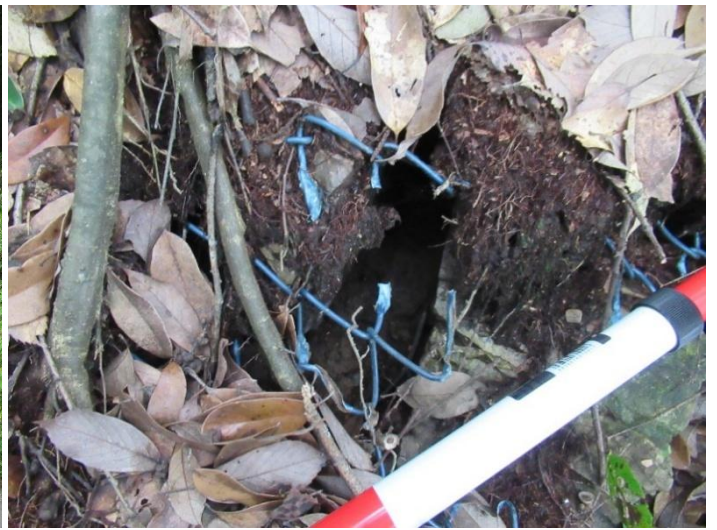
○皮膜付防護ネットの破断例
