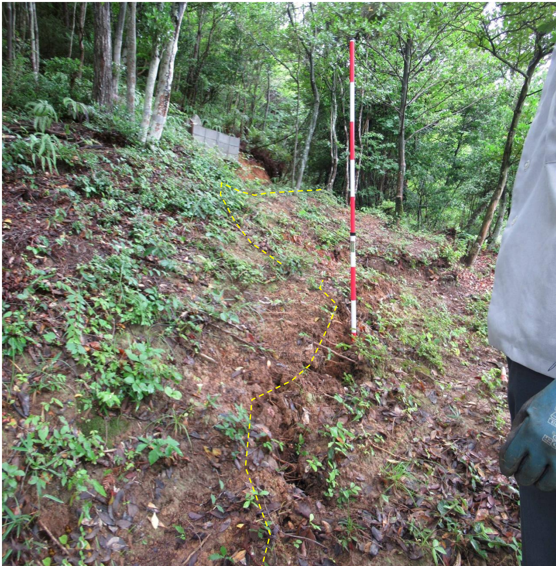
⑤ 冠頭部キレツ（右岸側～中央方向）：中央付近で落差1m程度
